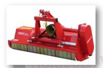
La trincia professionale AT è costituita da un rullo posteriore con estremità di forma sferica per la regolazione dell'altezza di taglio, rullo posteriore interno o esterno. Castello attacco a tre punti con attacchi registrabili, spostamento laterale idraulico di 350 mm di facile manutenzione. Robusto rotore di grande diametro disponibile con mazze stampate o coltelli
