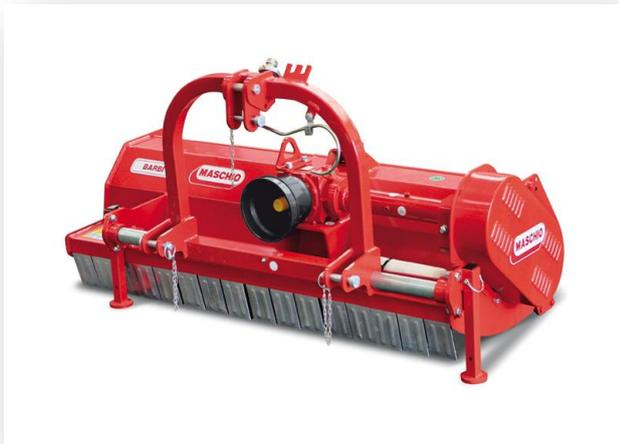
Il trinciata mod. BARBI si contraddistingue per la polivalenza d'impiego, essendo idoneo sia al taglio dell'erba sia alla trinciatura di piccoli sarmenti in vigneti e frutteti. E' possibile regolare il rullo in posizione interna alla camera di taglio, in base al tipo di trinciatura. Questo modello è disponibile in versione spostabile, meccanicamente o idraulicamente.
