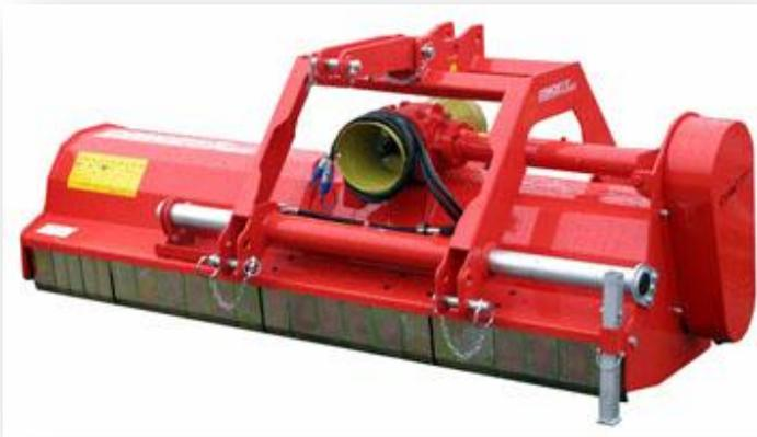
Semplice, robusta e affidabile. Cinghie della migliore qualità per la massima affidabilità della trasmissione laterale. Rullo posteriore con estremità di forma sferica per la regolazione dell'altezza di taglio. Speciale rotore antiurto.
