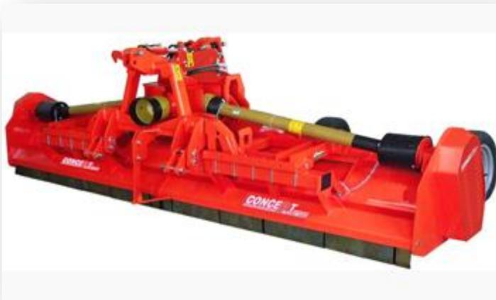
Rullo posteriore con estremità stampata di forma sferica per la regolazione dell'altezza di taglio. Robusto rotore di grande diametro disponibile con mazze stampate o coltelli. Cinghie della migliore qualità per la massima affidabilità della trasmissione laterale. Ruote posteriori pivotanti a richiesta.
