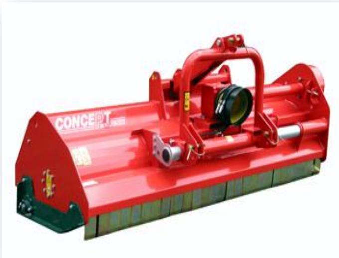
Con spostamento idraulico di serie, cofano regolabile e rullo posteriore, la trinciatrice MT rappresenta la soluzione più versatile per un gravoso uso professionale. Cinghie della migliore qualità per la massima affidabilità della trasmissione laterale. Rullo posteriore con estremità stampata di forma sferica per la regolazione dell'altezza di taglio. Spostamento laterale idraulico di 470 mm per superare agevolmente gli ostacoli.
