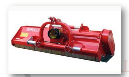
Con spostamento idraulico di serie, cofano regolabile e rullo posteriore, la trinciatrice MX rappresenta la soluzione più versatile per un gravoso uso professionale. Cinghie della migliore qualità per la massima affidabilità della trasmissione laterale. Rullo posteriore con estremità stampata di forma sferica per la regolazione dell'altezza di
