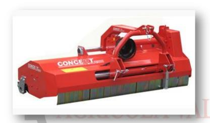
Il telaio realizzato con lamiera di grosso spessore, l'altezza di soli 40 cm, la forma piana e senza spigoli vivi della cofanatura, rendono il trincia PT la macchina ideale per gli usi più gravosi nei frutteti, vigneti e uliveti. Spostamento laterale idraulico di 450 mm interamente coperto dal cofano della macchina, questo per evitare che rami e frutti possano es-
