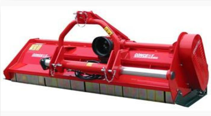
Con spostamento idraulico di serie, cofano regolabile e rullo posteriore, la trinciatrice TT rappresenta la soluzione più versatile per un gravoso uso professionale. Cinghie della migliore qualità per la massima affidabilità della trasmissione laterale. Rullo posteriore con estremità stampata di forma sferica per la regolazione dell'altezza di taglio. Spostamento
