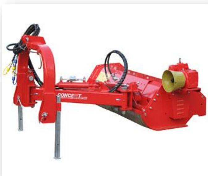
XS è la macchina ideale per trinciare fossi, argini, e siepi con trattori da 30 a 60HP, grazie alla sua costruzione leggera ma robusta. L'unità trinciante del collaudato modello XT garantisce un taglio ottimale in ogni condizione. Rotori di largo diametro con materiali stampati per i lavori più gravosi e la finitura dei prati. Lo spostamento Idi oltre 1.20 mt dal centro trattore permette di lavorare in modo sicuro con le ruote del trattore lontano dalle banchine.
