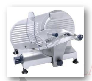
Carrello di precisione con eccezionali caratteristiche di scorrevolezza, premisalumi con puntine in acciaio INOX. Lama in acciaio INOX. Motori ad induzione a funzionamento continuo, con trasmissione a cinghia. Apparecchi professionali realizzati in fusione di alluminio, lucidati e anodizzati.
