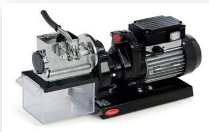
Ventola di raffreddamento, calotta copri - ventola e scatola interruttore-condensatore a tenuta stagna costruite in materiale plastico (carter in acciaio per versioni PROFESSIONALI). Motori elettrici ad induzione, a servizio continuo. Rullo dentato in acciaio stagnato, adatto per grattugiare formaggi (a pasta dura), pane, cioccolato, frutta secca. Corpo grattugia in alluminio alimentare (escluso modelli FIDO).
