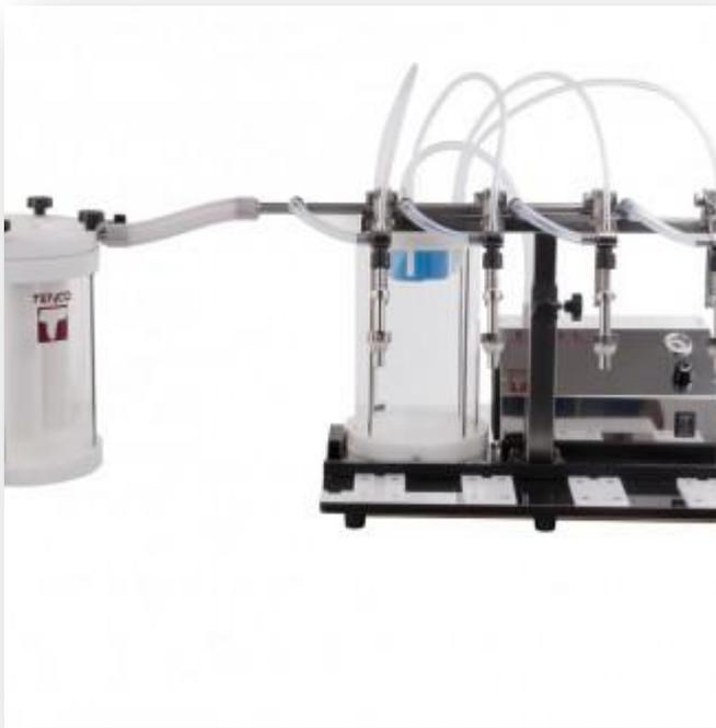
Filtro a depressione progettato per funzionare abbinato all'Enolmaster, consente di filtrare ed imbottigliare il prodotto con un'unica operazione.
