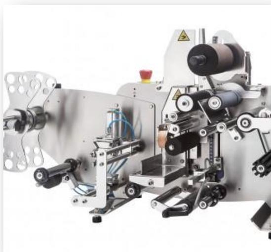
Kit per etichettare contenitori quadrati o sagomati. A funzionamento meccanico tramite carrello per il posizionamento della bottiglia. Rullo superiore in spugna di fermo bottiglia.
