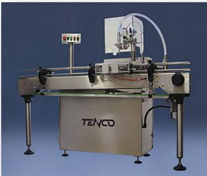
Una linea automatica per il riempimento volumetrico costituito dalla dosatrice pneumatica Dosamatic, che assicura un dosaggio preciso e costante. La dose è facilmente selezionabile, ed è compresa tra 40 e 1000 cc. L'alimentazione è ad aria compressa e corrente 380 V. I contenitori da riempire vengono caricati manualmente sul nastro che li convoglia alla stazione di riempimento.
