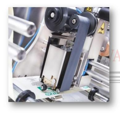
Marcatore a inchiostro: Completo di quadro di comando. Basetta portacaratteri a 3 linee. Caratteri in gomma comprensivi di 2 lettere "L", serie di numeri da 0 a 9 e n° 8 distanziali. Supporto in acciaio inox, 2 vaschette di inchiostro nero a rapida essiccazione. Aria compressa necessaria pari a 3 bar.
